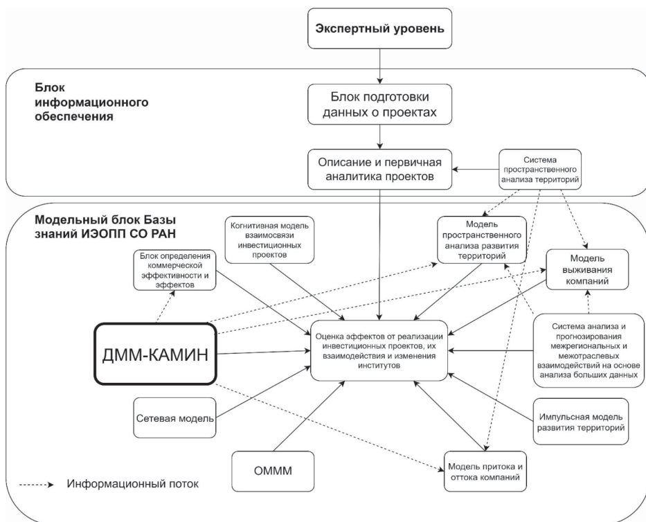
Рис. 2. Схема интеграции ДММ-КАМИН в модельный блок базы знаний ИЗОПП СО РАН
